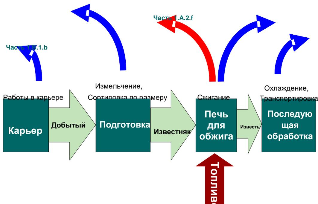
Рисунок 2-1 Производственная схема для категории 2.А.2 Производство извести
