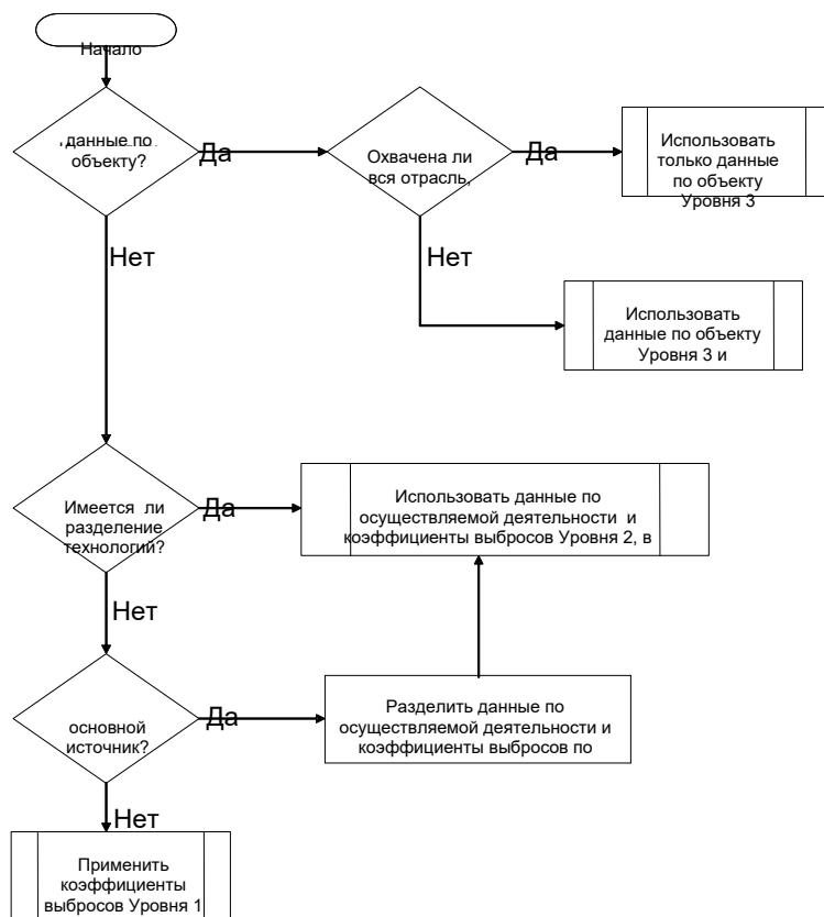
**Рисунок 3-1 Схема принятия решений для категории 2.D.3.с Битумные кровельные материалы**
