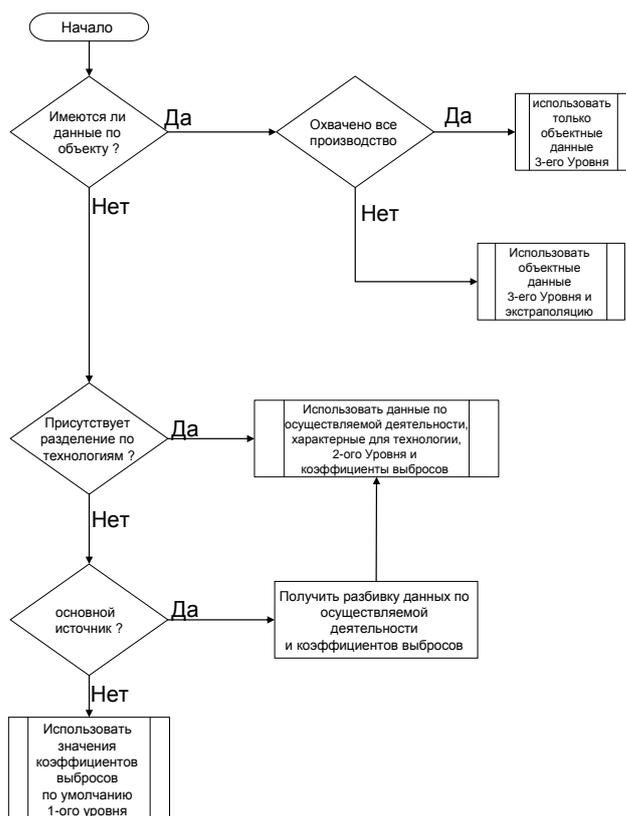
Рисунок 3-1 Схема процесса для категории 5.D Переработка сточных вод
