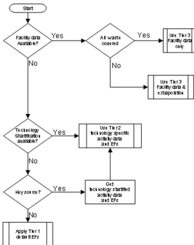
**Рисунок 3-1 Дерево принятия решений для категории источника 5.А Сбросы твердых отходов на землю**
