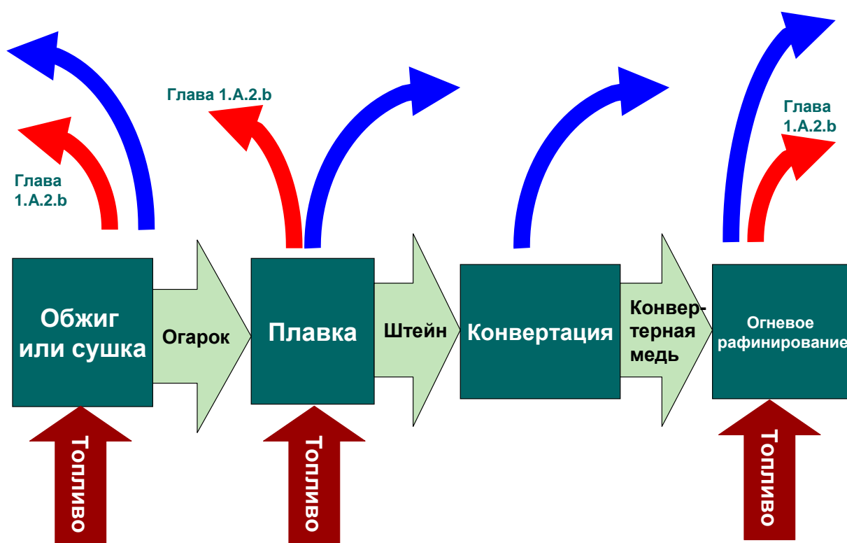
Рисунок 2.1 Схематическое описание технологического процесса медеплавильной печи с использованием рудного концентрата с кремнезёмистым флюсом в качестве загружаемого материала для обжига/сушки, анодной меди – при огневом рафинировании.
