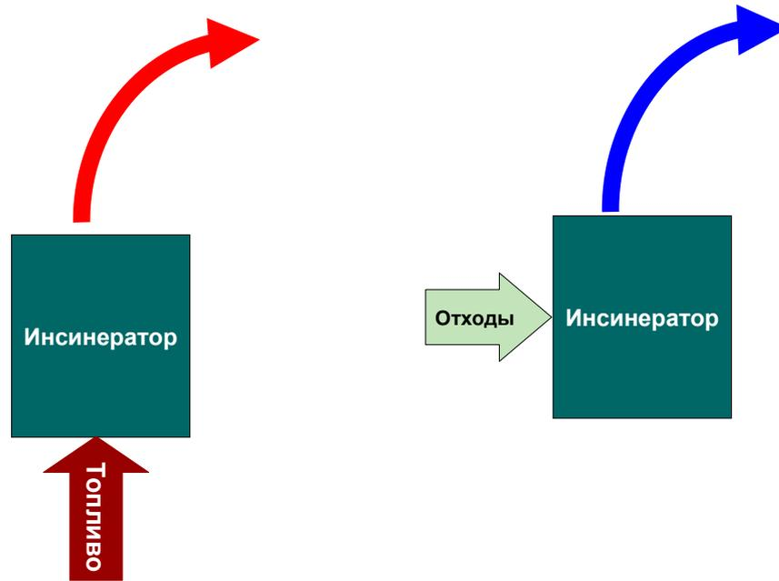
Рисунок 2-1 Схема технологического процесса для категории источника 6.С.с Сжигание бытовых отходов, с утилизацией тепла (слева) и без утилизации тепла (справа)
