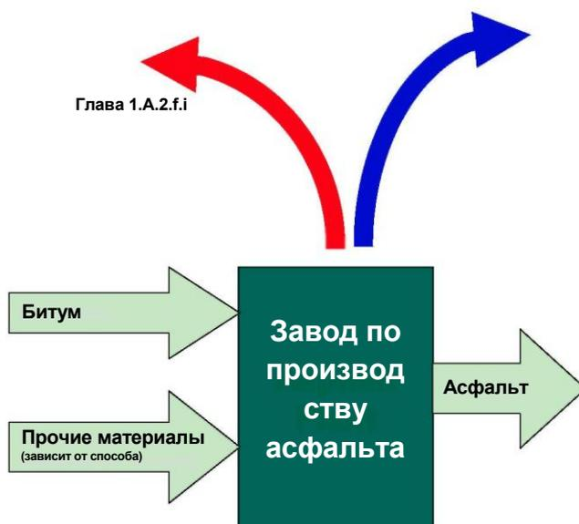
**Рисунок 2.2** Общая схема процесса для категории источника 2.А.6 Асфальтирование дорожного полотна. Красная стрелка представляет выбросы при сжигании (относится к категории источника 1.А.2.f.i) и синяя стрелка представляет выбросы процесса (рассматриваемые в настоящей главе).
