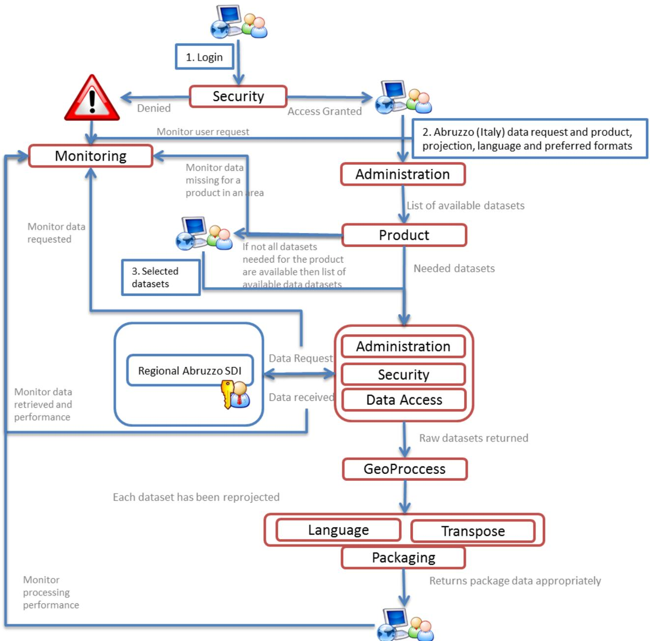
Figure 7 – Complete Scenario Diagram
