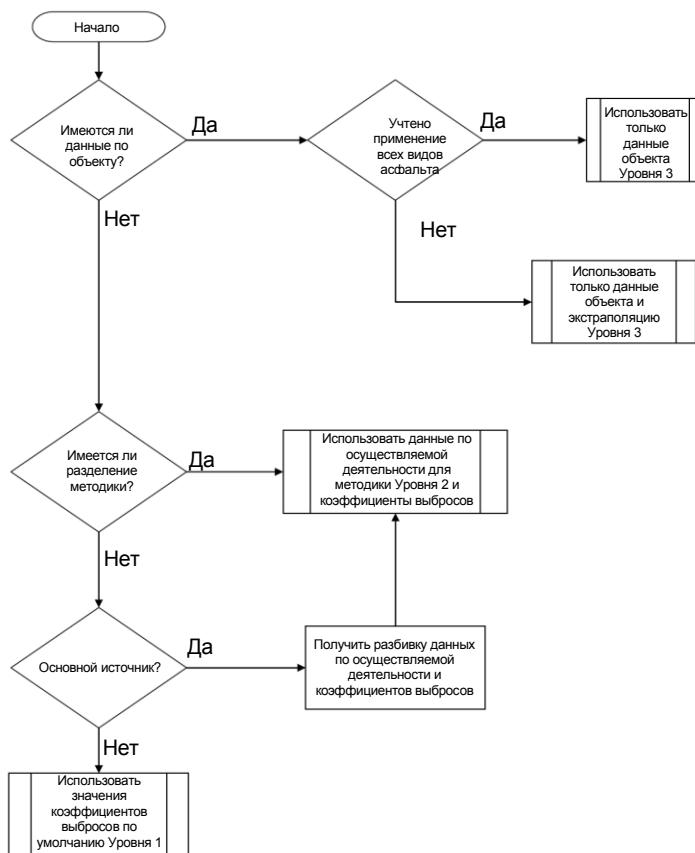
**Рисунок 3.1 Дерево решений для категории источника 2.А.6 Асфальтирование дорожного полотна**
